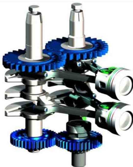
Tekening van de twee contraroterende krukassen en twee zuigerstangen per zuiger
