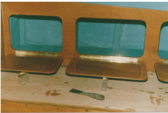
Opbergkastjes onder het gangboord
