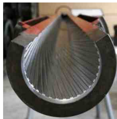
Opgezaagde "cilinder" van een kanon
