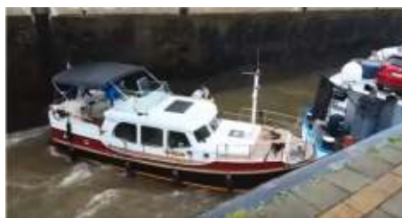
Een motorjacht loopt uit zijn roer door het schroefwater van een binnenschip. Beelden van Youtubefilmpje Start2Boat
